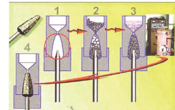
Специально обработанные алмазные зерна максимально плотно засыпаются в форму. В вакуумной печи при температуре 1000°C зерна привариваются друг к другу и специальный сплав заполняет промежутки между зернами, еще больше упрочняя конструкцию. Таким образом алмазный инструмент получает качества, недоступные другим технологиям + никаких ограничений по форме.
