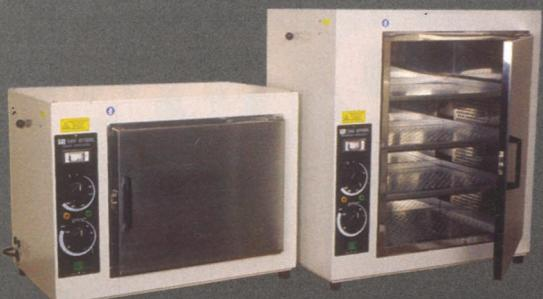
Сухожаровые стерилизаторы объемом 20, 36 и 60 литров
